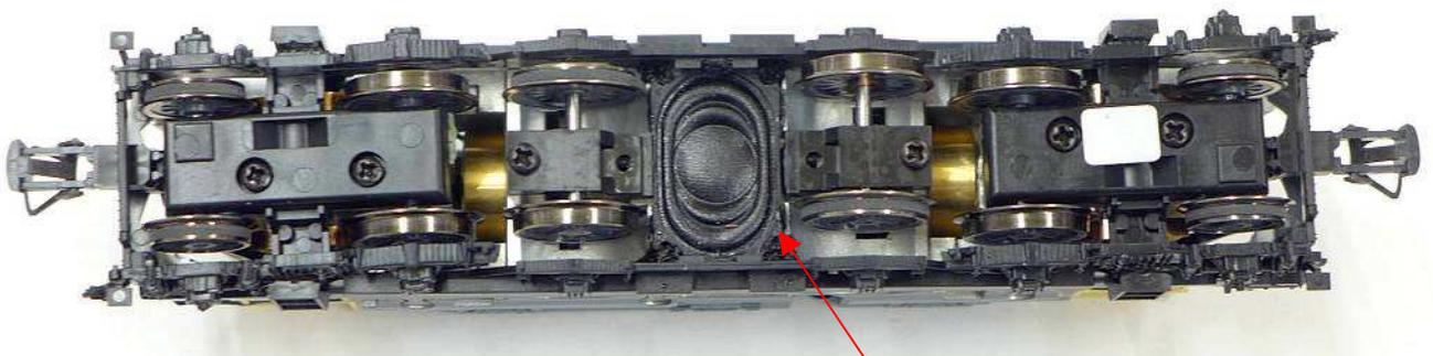
Lautsprecher ESU 50330 mit Kleber fixieren, Löcher und Spalten mit Dichtmasse schließen
