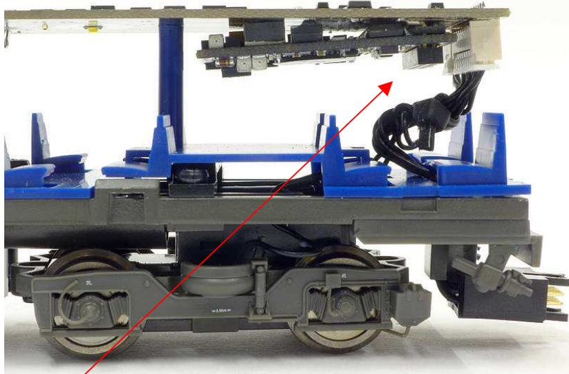
Decoder bis zum Anschlag auf die Schnittstelle stecken
